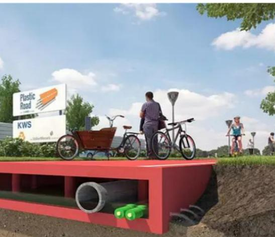
用科技的手段，将塑料压缩成了最小密度，足以支撑车辆运行，并且温度承受范围较大，最低可达零下40度，最高可达80度。
