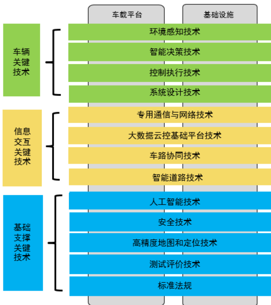
图 1 智能网联汽车“三横两纵”技术架构
